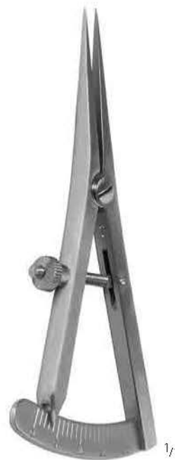
CASTROVIEJO AR 282/20 8,0 cm/3 \frac{1}{4} " Messbereich 20 mm measuring range 20 mm campo de medición 20 mm étendue de mesurage 20 mm ampiezza di misura 20 mm
